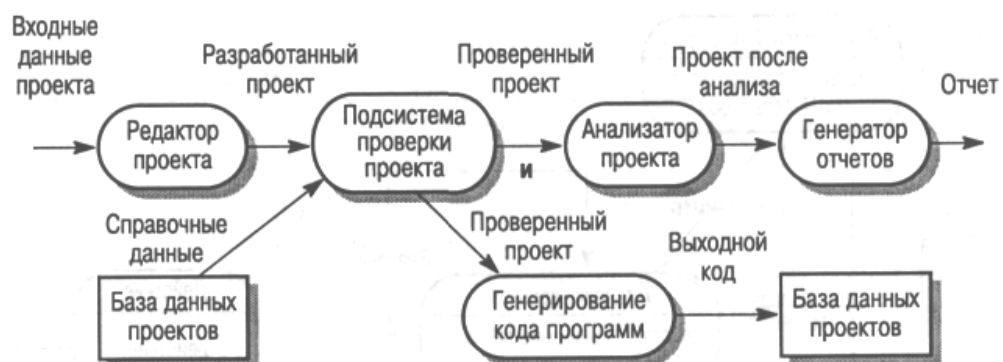
Рисунок 27 - Диаграмма потоков данных комплекса CASE-средств
